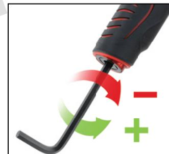
**Вы можете настроить скорость стрельбы посредством регулятора Hyper5™, расположенного в передней рукоятке. Чтобы отрегулировать скорость, вставьте шестигранник 3/16" (5 мм) в нижнюю часть рукоятки. Поворачивая ключ по часовой стрелке, то есть, закручивая регулятор внутрь, Вы уменьшите выходное давление. Поворачивая ключ против часовой стрелки, то есть закручивая регулятор наружу, вы увеличите выходное давление и, соответственно, скорость стрельбы.**
