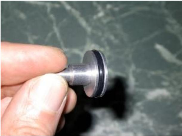
6. Из нижней части выкручиваем регулировочный винт.
