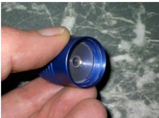
14. Наносим смазку внутрь нижней части.
