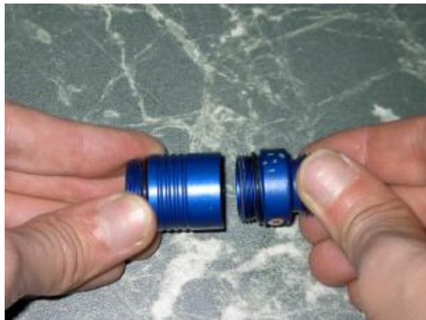
3. При помощи ключа 5/32 выдавливаем поршень из средней части регулятора.
