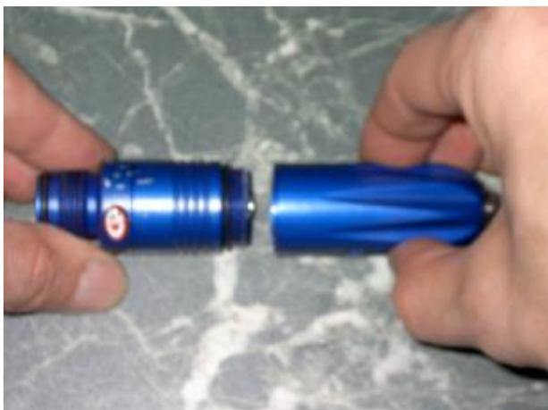
2. Откручиваем верхнюю часть регулятора.
