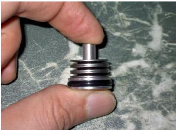
12. Наносим на пистон и резиновое кольцо смазку DOW33 и равномерно размазываем по всей окружности.
