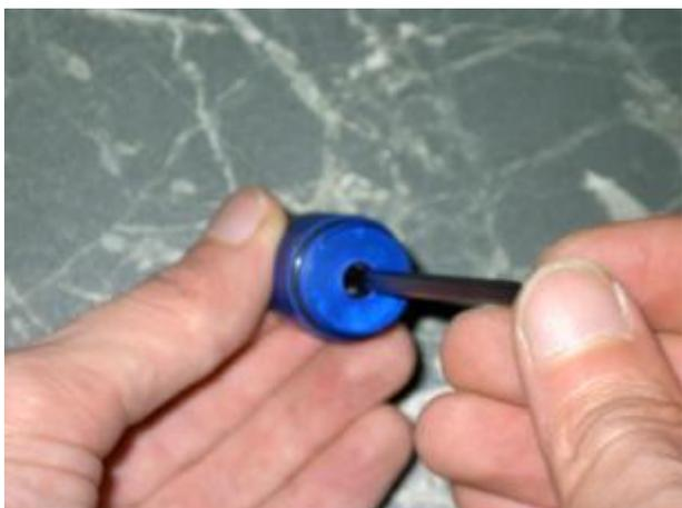
4. Вынимаем поршень.
