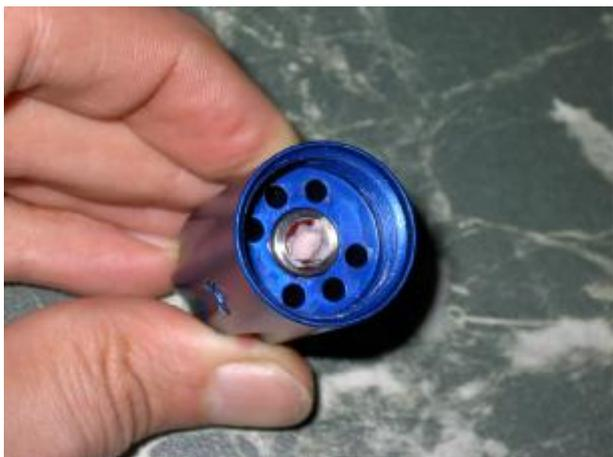
18. Закручиваем регулировочный винт в нижнюю часть.
