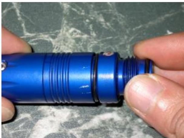
**Перед тем как подать на регулятор воздух - ОБЯЗАТЕЛЬНО закрутите до упора винт регулировки давления!!! И только после это можно снова приступить к настройке давления.**
