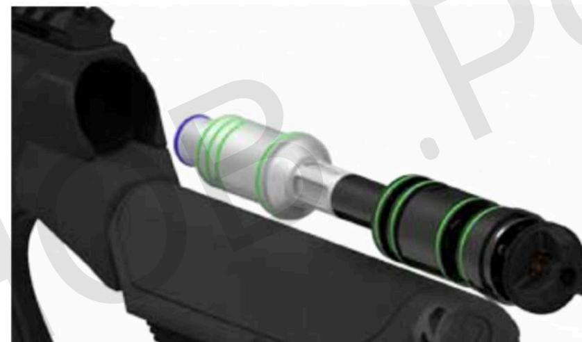
открывается клапан болта, и воздух из подающего отсека проходит через болт и выстреливает пейнтбольный шар. После этого соленоид деактивируется, а воздух через соленоид попадает в камеру (cap). Это заставляет болт вернуться в заднее положение, а камера перезаряжается.
