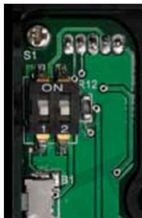
**ВОЗВРАТ К ЗАВОДСКИМ НАСТРОЙКАМ** - Когда переключатель №1 включен (в заднем положении), программа выполнит откат до заводских настроек. Этот режим используется для устранения неполадок в маркере. Если переключатель №1 выключен (в переднем положении), программа вернется к настройкам пользователя.
